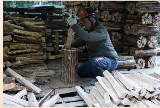
番線詰め作業
