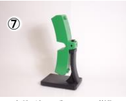
改質リグニン系フェノール樹脂 摩擦材(鉄道用ブレーキシュー)
